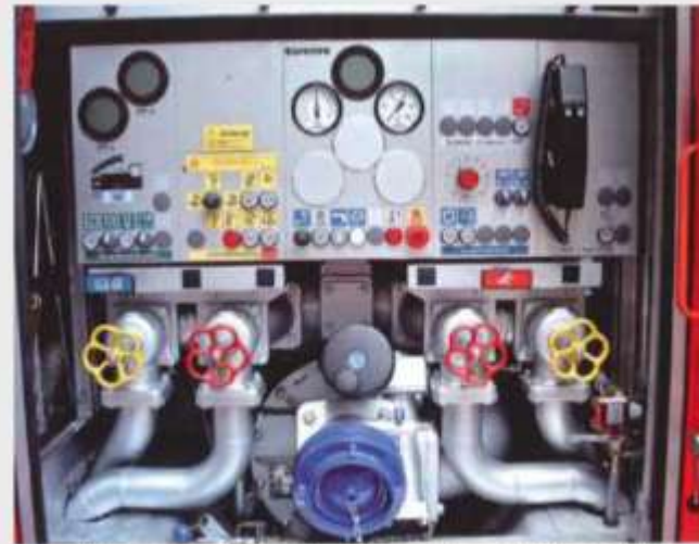
Abb. 4.9.1.8/1: Automatische Pumpendruckregelung der Fa. Magirus (Foto: Ossendorf, Stuttgart)
